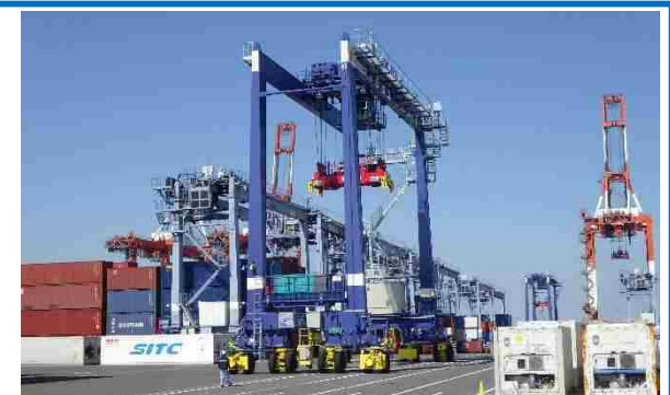
遠隔操作RTG
