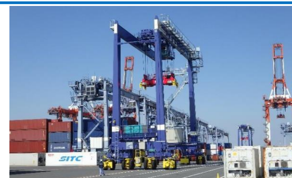
遠隔操作RTG
