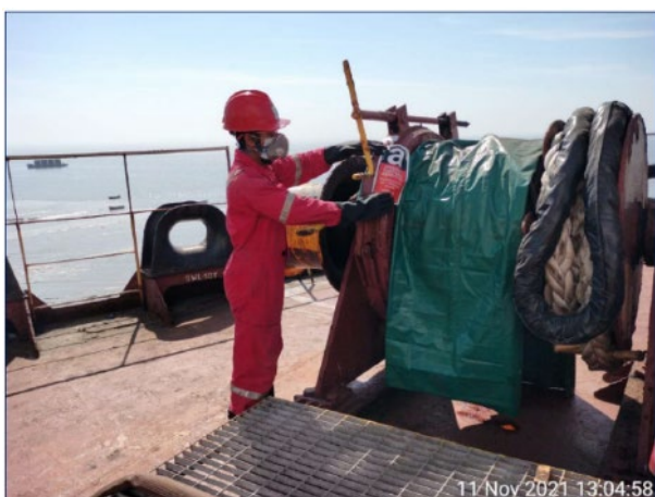
IHM レポートに基づく有害物質マーキング
