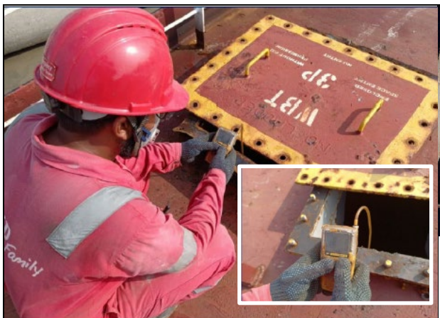
ガス計測作業
