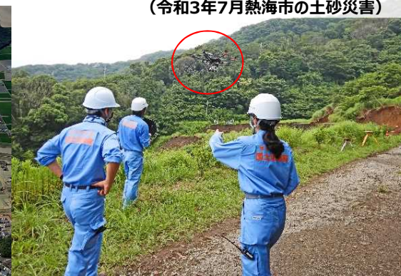
ドローンによる航空レーザ測量 (令和3年7月熱海市の土砂災害)
