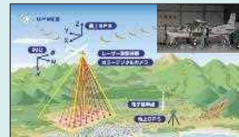
主要な基準点のみ現地測量し、 上空からの写真や画像上から 土地の境界点の座標値を算出
