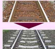
マクラギを木からコンクリートへ
