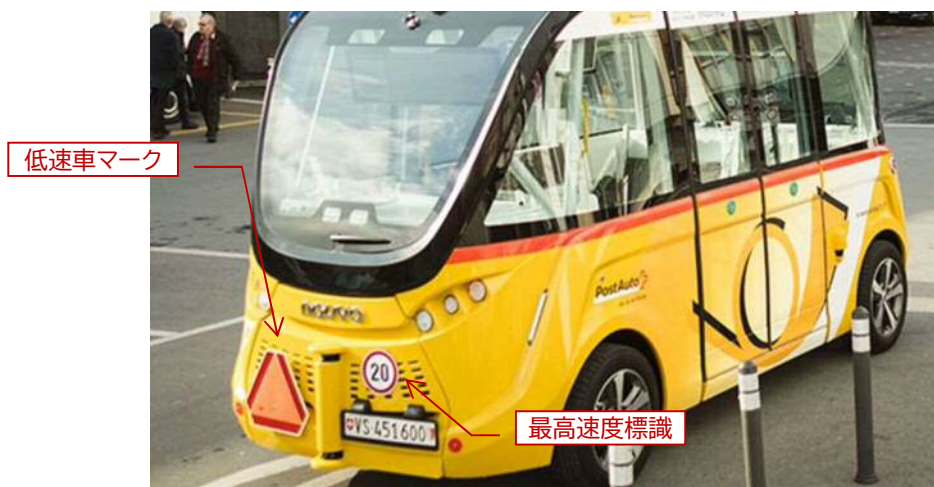
図 スイス ヴァレー州シオンのグリーンスローモビリティ（自動運転車両）
