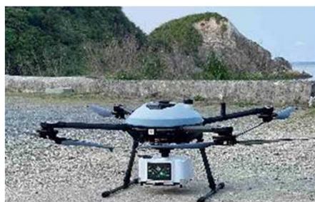
グリーンレーザー搭載ハイブリッドドローン (メーカー側で、ガソリン燃料発電機よりバッテリーに給電可能としたハイブリッド型ドローンを開発し、長時間飛行による測量、空撮が可能となった。)
