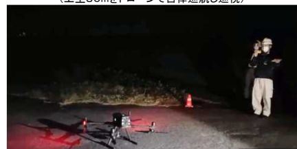
赤外線カメラ搭載ドローンによる夜間の人物の判読
