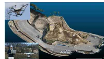
ドローンを用いた写真測量による面的な3次元測量を実施
