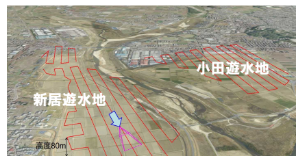
ドローンの巡視ルート[赤線] (上空80mをドローンで自律巡航し巡視)
