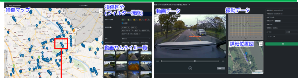
【図-2 検知損傷の閲覧画面】
