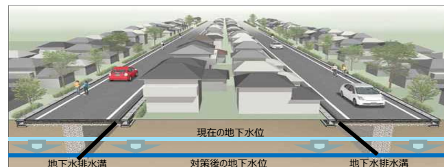
道路と宅地との一体的な液状化対策を行う工法のイメージ（地下水水位低下工法）
