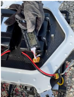
重心を安定させるための搭載方法例
