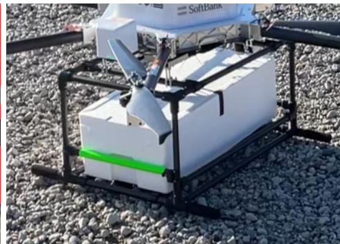
ドローン本体と荷物をラックにて固定方法例
