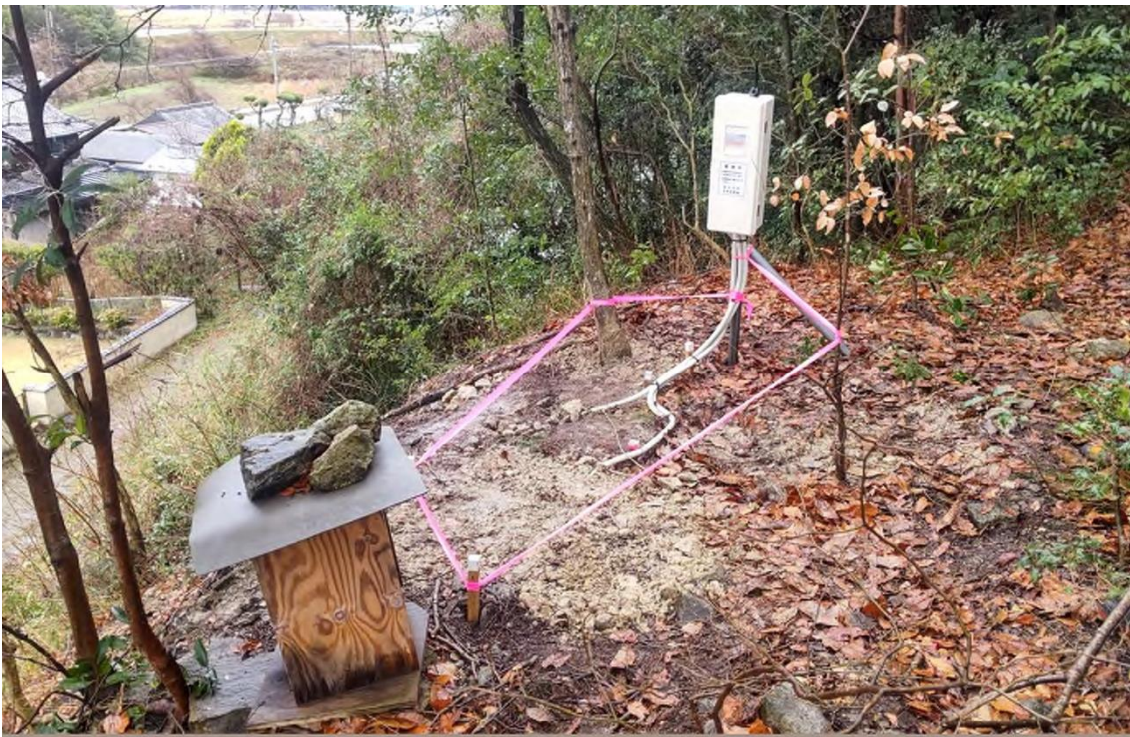
土壤水分計全体設置状況
