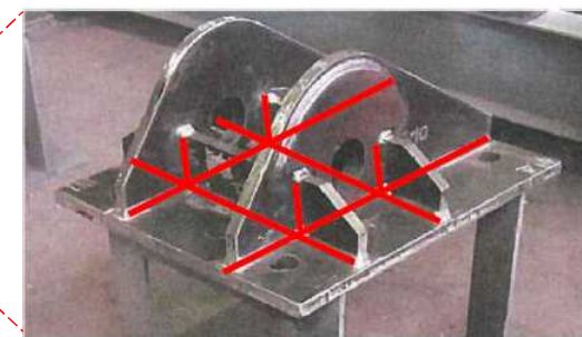
— 完全溶け込み溶接部
